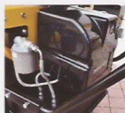
Cierre de depósito de combustible antifugas, con indicador de nivel
