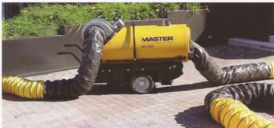
Recirculación de aire Se emplean 2 conductos - 2 x ø 300 mm
